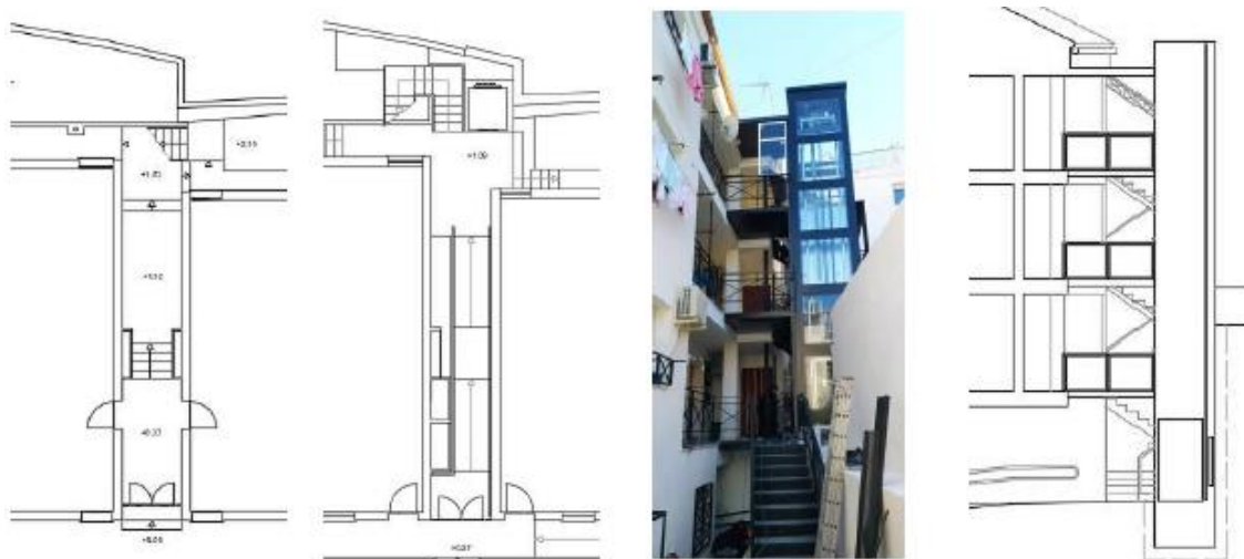
Figura 3. Ascensor en zonas comunes exteriores: planos de planta baja, estado actual y reformado; sección y fotografía, estado reformado. Fuente: Junta de Andalucía. Agencia de Vivienda y Rehabilitación de Andalucía
