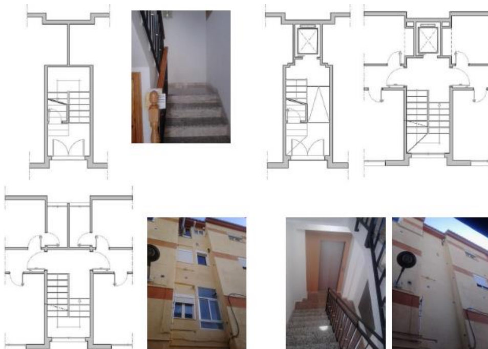
Figura 5. Ascensor en zonas privadas: planos de plantas y fotografías, estado inicial y reformado. Fuente: Levantamiento propio de actuaciones subvencionadas por la Junta de Andalucía
